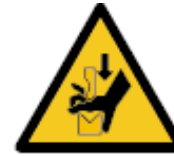
Quetschgefahr der Hand zwischen den Werkzeugen einer Presse
